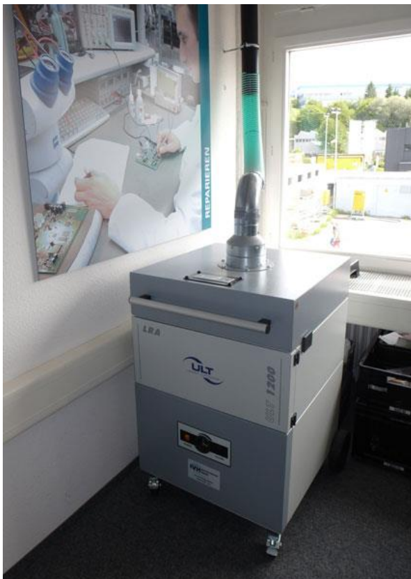
Bild 4: LRA 1200 als zentrale Absauganlage für Lötrauch
