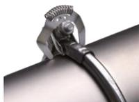
Bei der Absaugung von brennbaren Stoffen und in Ex-Zonen ist es wichtig darauf zu achten, dass ein elektrisch leitfähiges Rohrsystem verwendet wird, um einen Explosionsschutz zu garantieren. Hierzu empfiehlt die ULT AG ein Spannringsystem mit Erdungsbrücken.
